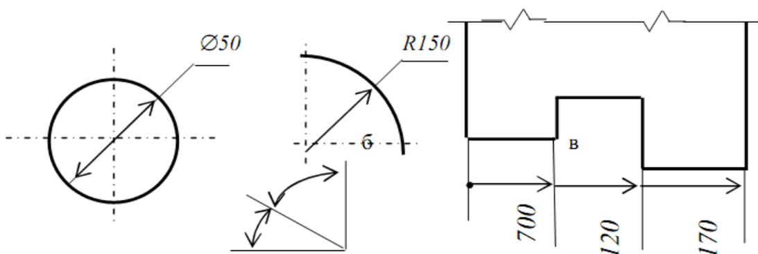
Рис. 2 Примеры применения стрелок (а–г) для нанесения размеров на строительных чертежах
